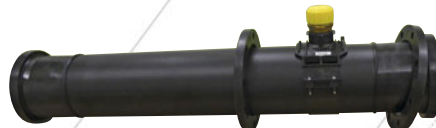
PE-Rohr Da 225, zum Einflanschen in die Versuchsapparatur.
